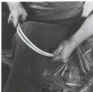
Cintrage des poignées. Les deux armatures des poignées ou petites anses sont galbées ensemble sur le genou.
