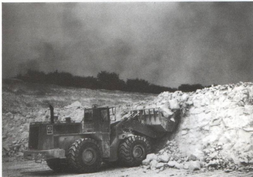
L'excavatrice moderne. Sept à huit tonnes d'un coup de dents
