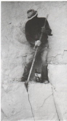
La « pince » détache et déplace les blocs.
