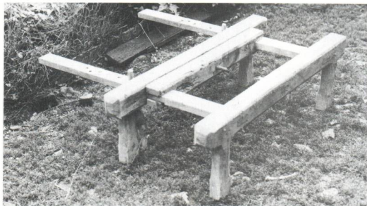
Appareil permettant le traçage des mortaises à Rigny-le-Ferron (A.).
