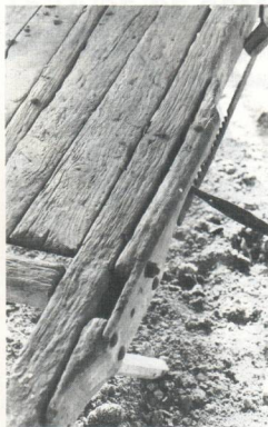
Sabot de bois et mécanique d'un camion.
