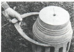
Contrôle du diamètre du moyeu.
