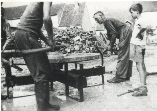
Ph. R. Louvrier. Villiers-le-Sec. H.M. On remarque, à droite, l'emploi du poinçon, dans la main droite et, à gauche, le maniement du levier tireur.
