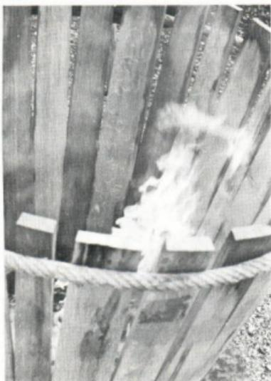
Mue par une sorte de volant, la vis de la presse tire sur la barre mobile qui glisse vers l'arrière, entraînant la corde avec elle. Cette corde « ramasse » les douves en une circonférence dont le diamètre diminue. L'ouvrier les bride alors avec un nouveau cercle.
