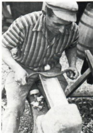
Le tonnelier dispose d'une **plane**, sorte de couteau à deux poignées, dont il existe plusieurs modèles diversement cambrés. Avec cet outil, il travaille sa douve de façon à lui donner cette légère convexité que laisse pressentir la cambrure du tonneau fini.
