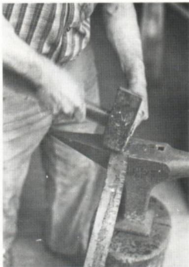
la cambrure du tonneau. A ce moment, l'artisan pose un second rivet, remet définitivement le cercle en place et passe à la confection du suivant.
