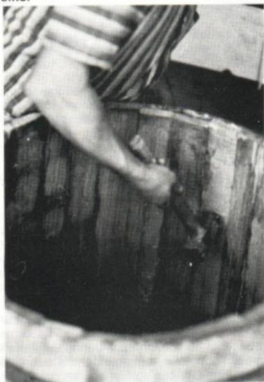
De même « ajuste »-t-il ses douves de façon que toutes se présentent en hauteur sur le même plan. A cet effet, il emploie un serre-joint, à cheval sur deux
