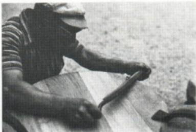
resserrés avec la chasse et le marteau. Pour poser le deuxième fond, il lui suffira d'introduire un doigt dans le trou percé pour le robinet et de le présenter juste en face du jable du tonneau, non sans avoir, au préalable, desserré les cercles.
