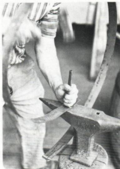
Le cercle de tête est le plus délicat à réaliser. En effet, le diamètre des autres peut varier sans inconvénient de quelques millimètres. Il n'est pas gênant que les cercle ne se trouvent pas très exactement à l'endroit prévu. Il n'en est pas de même pour le cercle de tête, qui doit affleurer très précisément à l'extrémité des douves, sous peine de
