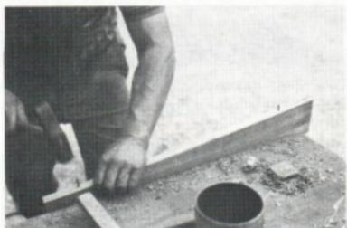
Le tonnelier a pris soin d'interposer une latte entre son marteau et la tranche de cette autre planche. Et ainsi de suite. Avec la dernière, le chanteau; il n'est plus besoin de latte de protection puisqu'elle sera découpée et travaillée en épi. Elle doit, en effet, s'introduire exactement dans le jable qui a été pratiqué pour la recevoir.
