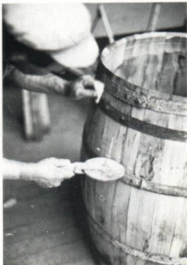
La cisaille mord. Avec la bande de feuillard qu'il vient de détacher, le tonnelier va réaliser son cercle.
