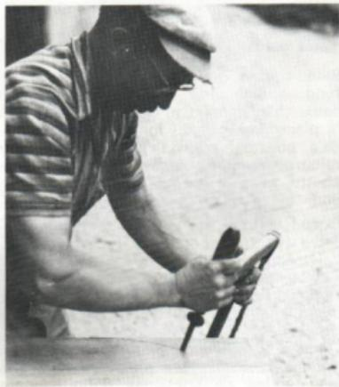
Avant de goujonner, il a noté l'emplacement des goujons, de façon à ce que ceux-ci ne puissent gêner la scie dans le découpage. Il a ensuite assemblé ses douves sur son étau. La première douve reçoit les deux pointes à tête coupée qui doivent l'unir à la seconde. Celle-ci vient s'appliquer contre elle en s'enfonçant sur la moitié supérieure des goujons.
