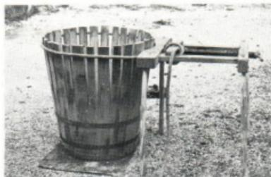
Cet instrument, monté sur pieds, se compose d'un cadre, (généralement de bois) dont l'un des côtés, qui est convexe s'adapte à la courbure du tonneau. En son milieu tourne une vis sans fin qui
