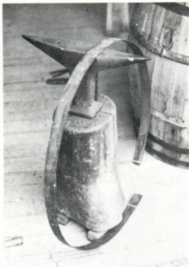
Sur l'enclume, il perce le trou d'un rivet puis, toujours sur l'enclume, avec un marteau, il donne l'écouage... Il frappe tous les centimètres environ, sur le même bord, de façon à ce que, de ce côté, le feuillard prenne plus de largeur et qu'ainsi, le cercle s'évase.
