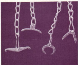
Différents types de clavettes de collier.
