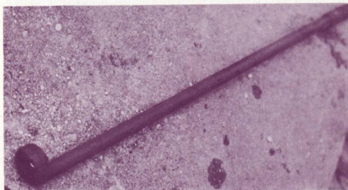
Le « tourne-à-gauche » qui, avec les « plie-mailles », sert à former le maillon à froid.
