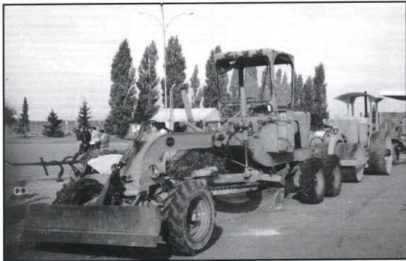
Niveleuse et rouleau compacteur
