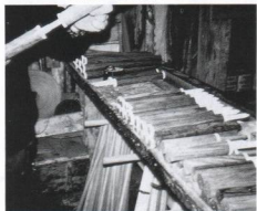
Finition au grattoir d'une tige de queue à vis.
