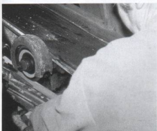
Finition à la molette de l'enture de la tige.
