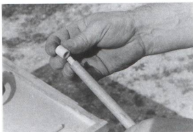
Mise en place de la virole en bout de queue.
