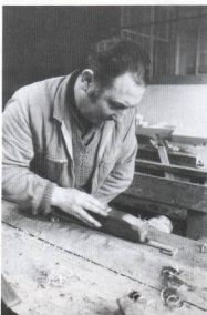
Effilage au rabot de la tige d'une queue à vis par M. René Bardin.
