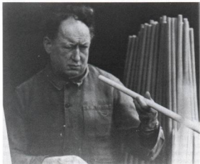
Vérification du dressage "à l'œil". Cette action se disait "bornoyer".
