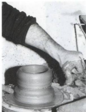
10. Un troisième cylindre est façonné et tronçonné au fil.
