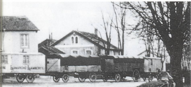
La locomobile du T.N.P. Lamarche-Lamberty vers 1906-08. Lors des représentations, ce tracteur fournissait l'électricité pour l'éclairage du théâtre.
