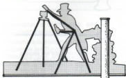
Girouette avec embase à bord roulé armé d'une tige de fer et figurines raidies par un squelette en fil de fer soudé.
